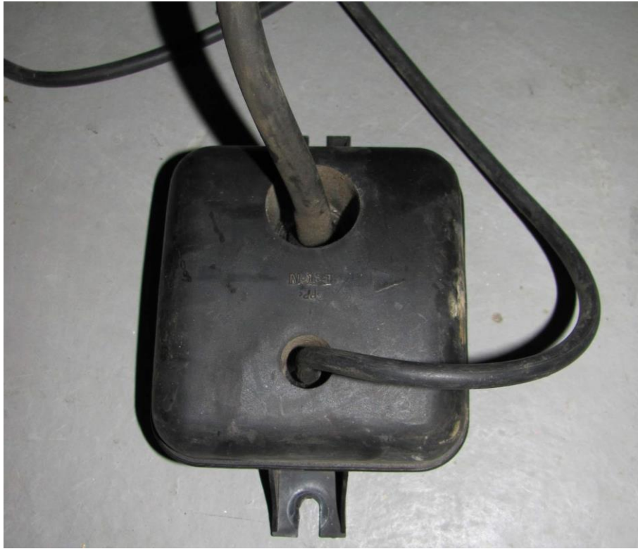
Obr. 15 Zásobník podtlaku s vedením
