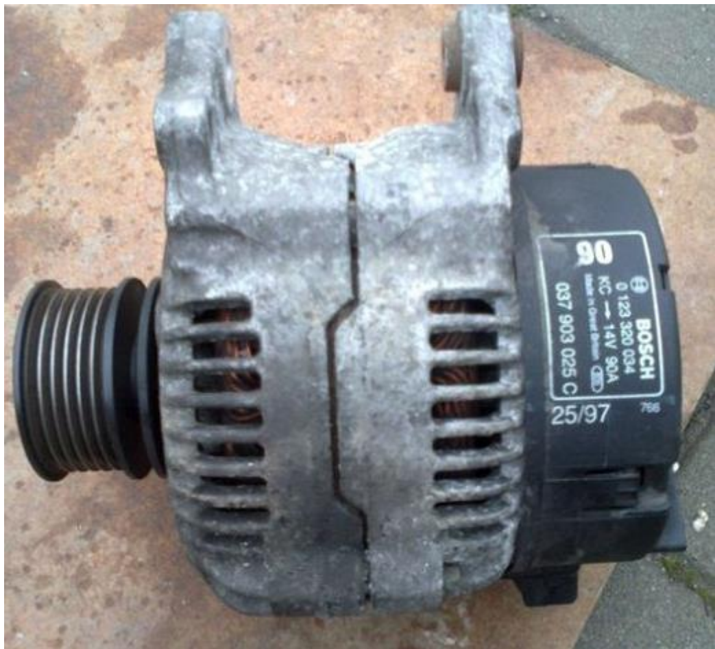
Obr. 7 Alternátor 90A pro vozy s klimatizací
