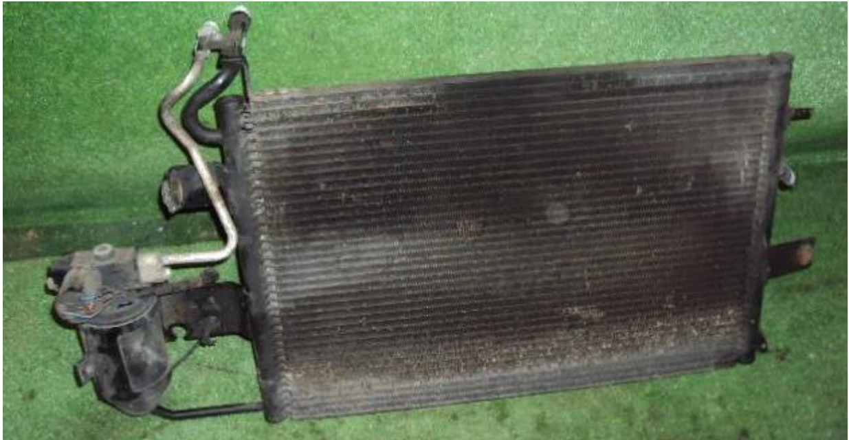
Obr. 10 Kondenzátor klimatizace s vysoušečem / zásobníkem chladicího média
