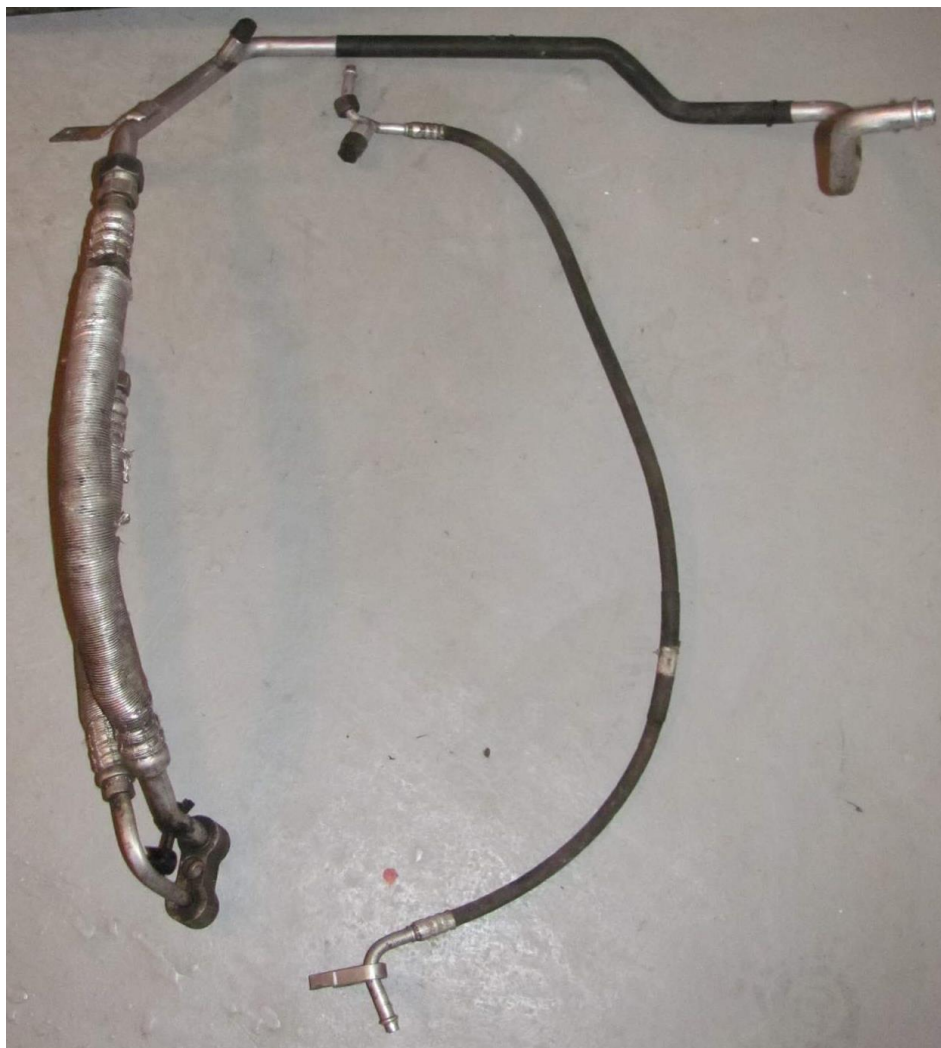
Obr. 17 Nízkotlaká a vysokotlaká hadice od kompresoru k expanznímu ventilu klimatizace
