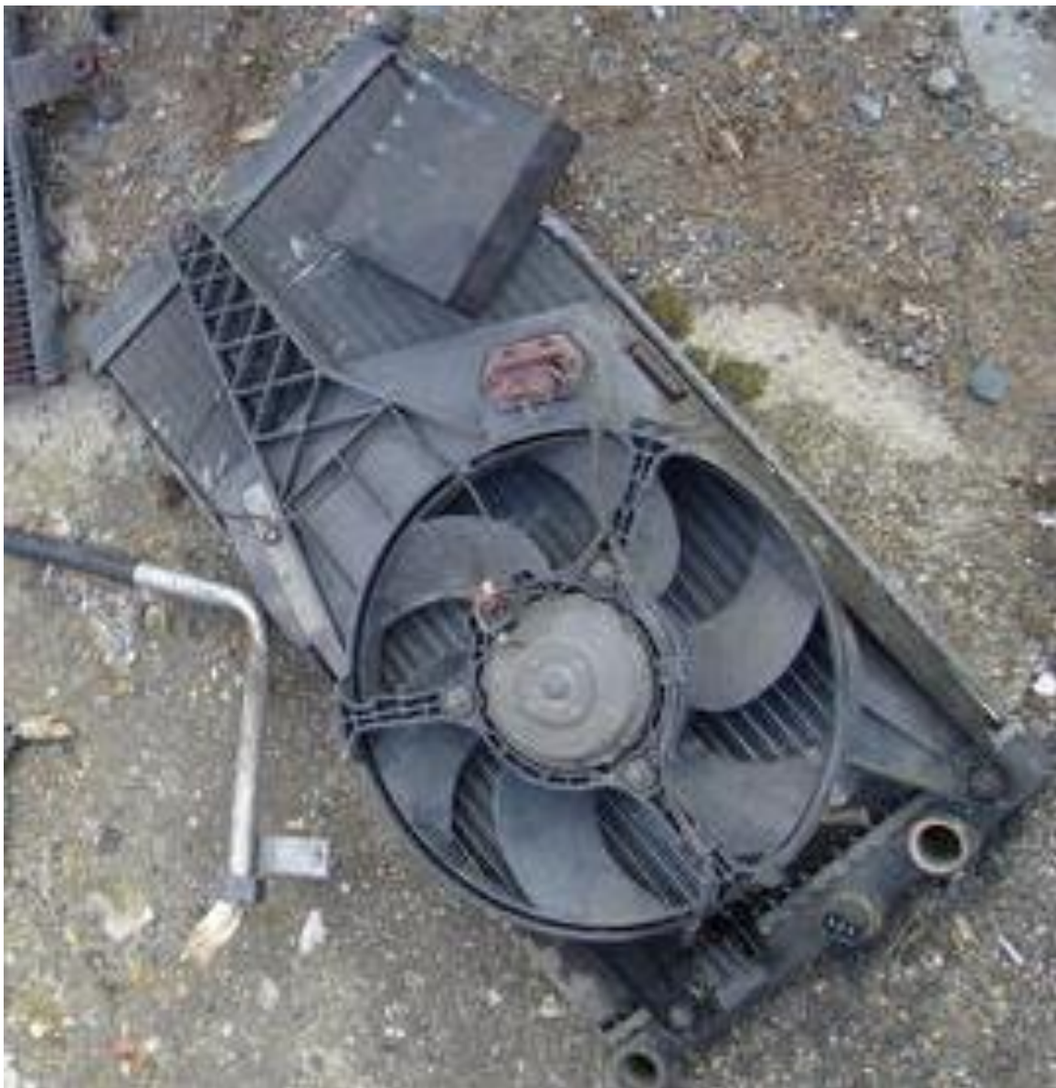
Obr. 11 Dvoustupňový ventilátor chladiče s chladičem
