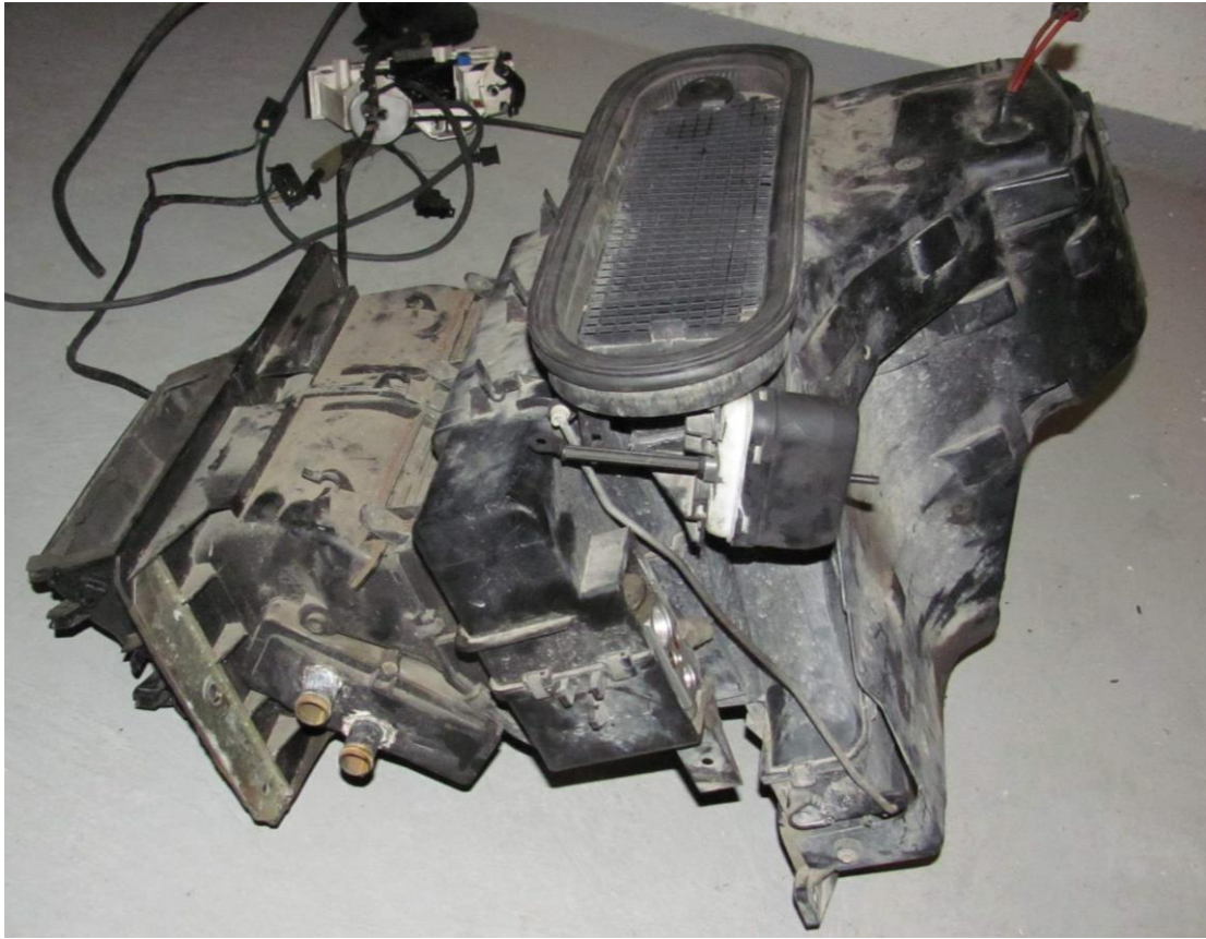
Obr. 3 Těleso topení s výparníkem, radiátorem, ventilátorem, expanzním ventilem, klapkou vnitřní recirkulace
