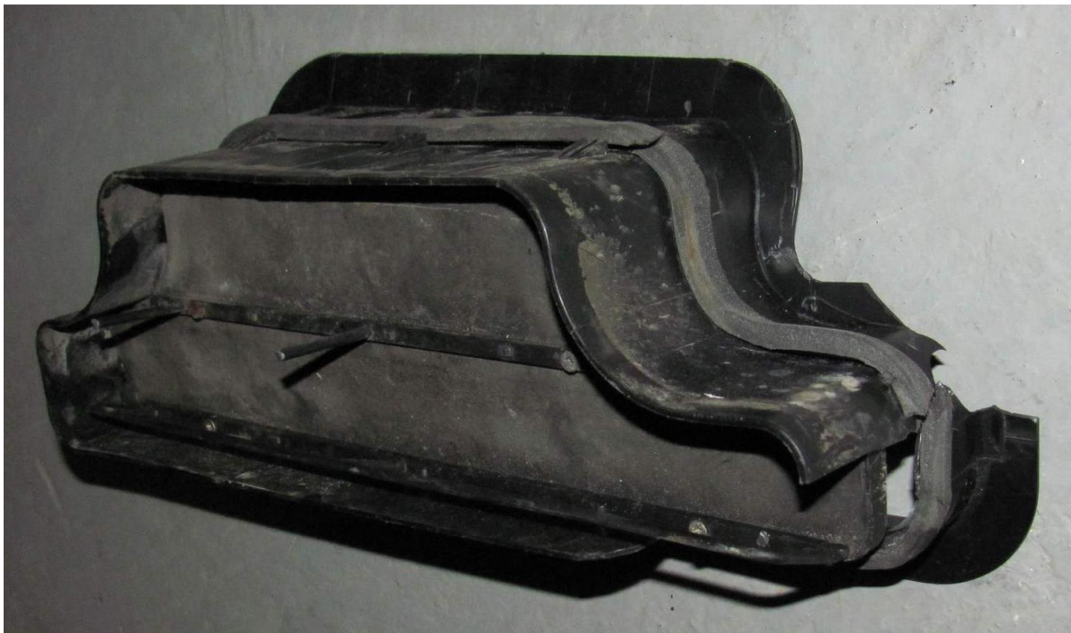
Obr. 8 Rámeček pro vnitřní recirkulaci vzduchu
