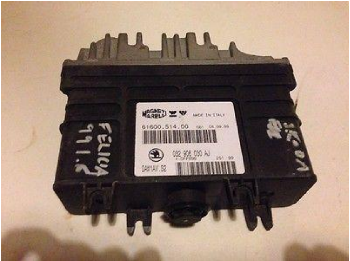
Obr. 6 Řídící jednotka motoru AJ nebo AG pro motory s klimatizací
