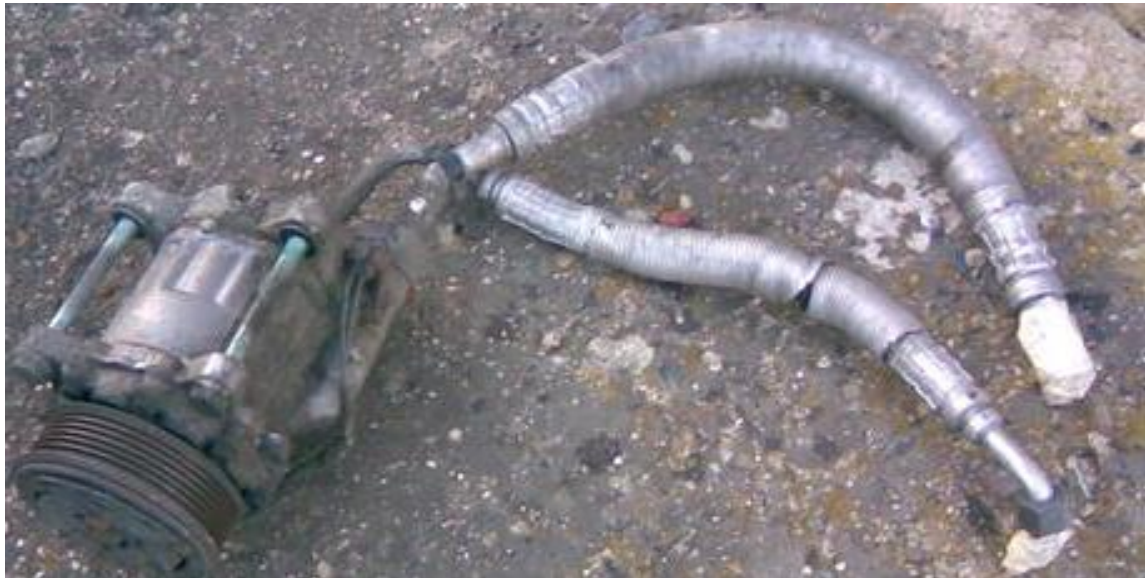
Obr. 13 Kompresor klimatizace s vedením
