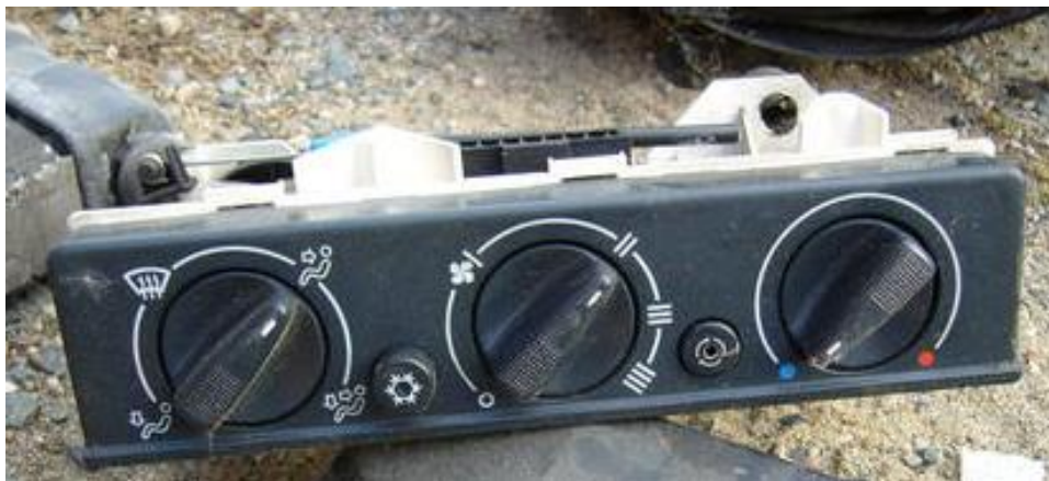
Obr. 19 Detail ovladačů klimatizace
