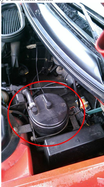
25. Demontáž vlastní nádoby s aktivním uhlím
